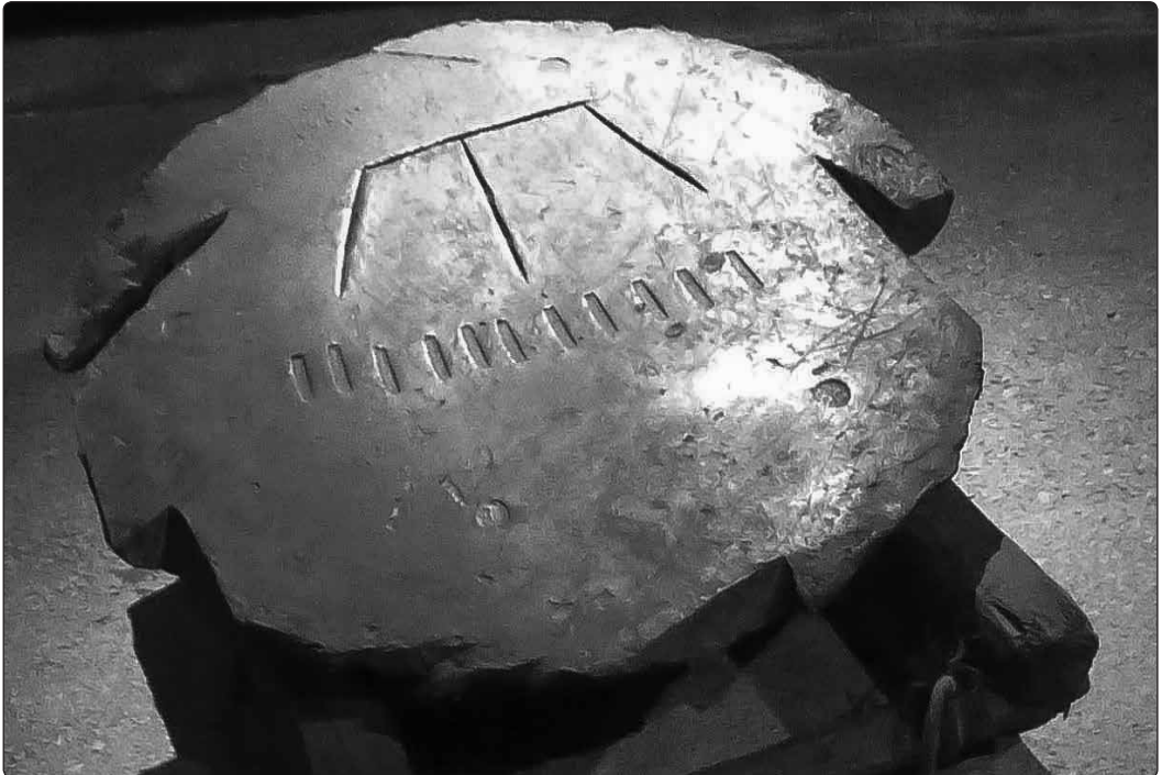
Il. 4. Widoczne na ołowianym bochnie nacięcia przedstawiają literę E – jest to prawdopodobnie gmerk wytwórcy, pozostałe zaś nacięcia oznaczają wagę bochna w cetnarach (w tym przypadku 11 cetnarów). Fot. Agnieszka Kaczmarczyk
