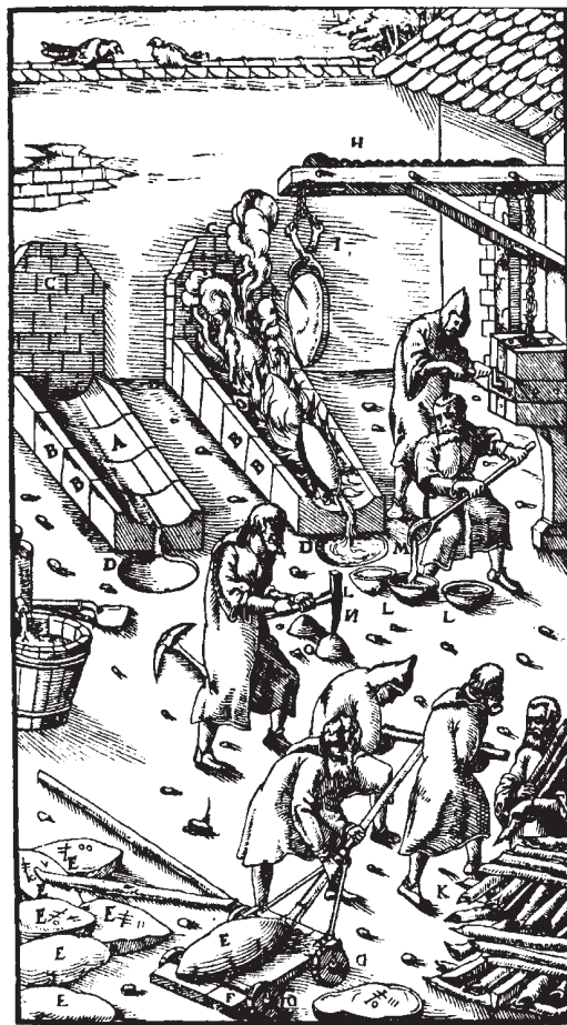
Wytapianie ołowiu i formowanie bochnów, na podstawie G. Agricoli De re metallica libri XII , Bazylea 1556 (ryc. 4)
