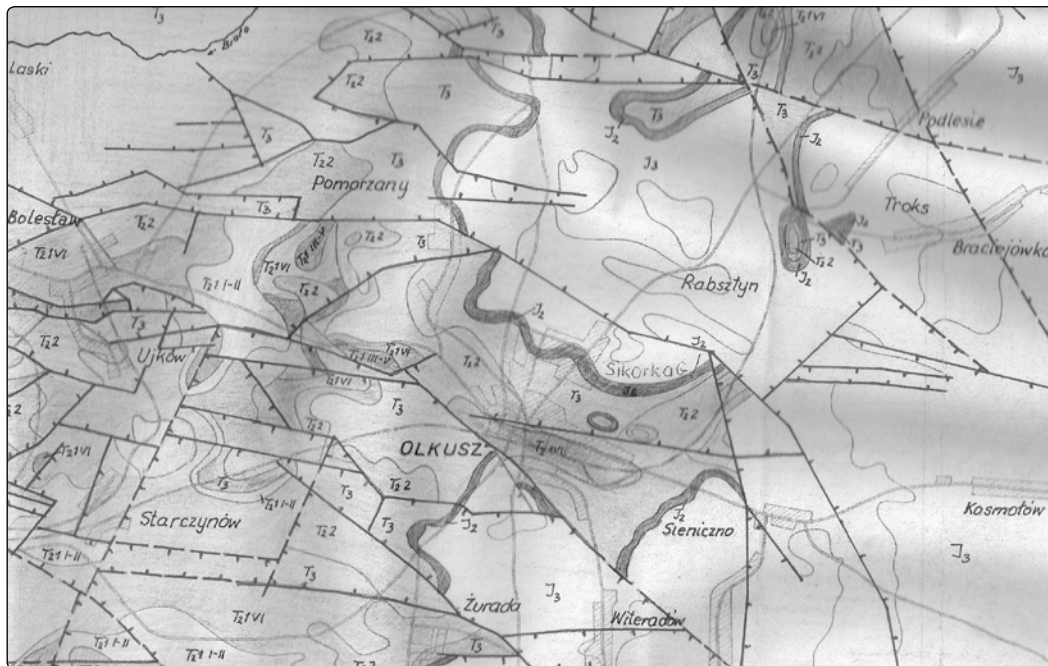
Il. 2. Wycinek mapy geologicznej odkrytej na podstawie dokumentacji geologicznej złoża rud cynku i ołowiu Sikorka w kategorii C1 J3 - jura górna (Malm), J2 - jura środkowa (Dogger), T3 - kajper (trias górny), T22 - dolomity diploporowe (trias środkowy), T21VI - dolomity kruszczońskie (trias środkowy), T21 III - V - warstwy gorazdeckie, terebratulowe, karchowickie (trias środkowy), T21 I - II - warstwy gogolińskie (trias środkowy), T13 - ret (trias dolny), - uskoki, - wychodnie warstwy
